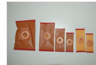
Kurs Herstellung von verschiedene Formen von Membranen, die in den unterschiedlichen Techniken der Pneumatik angewendet werden.
